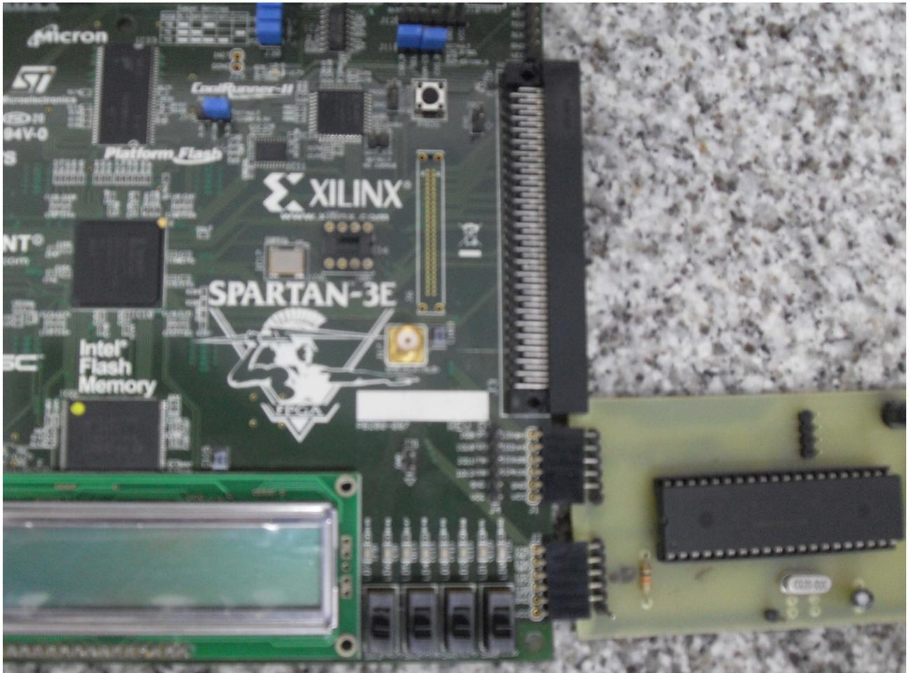
*Figura 4: Conexão entre a Plataforma Xilinx Starter-3E e a Scorpion*
