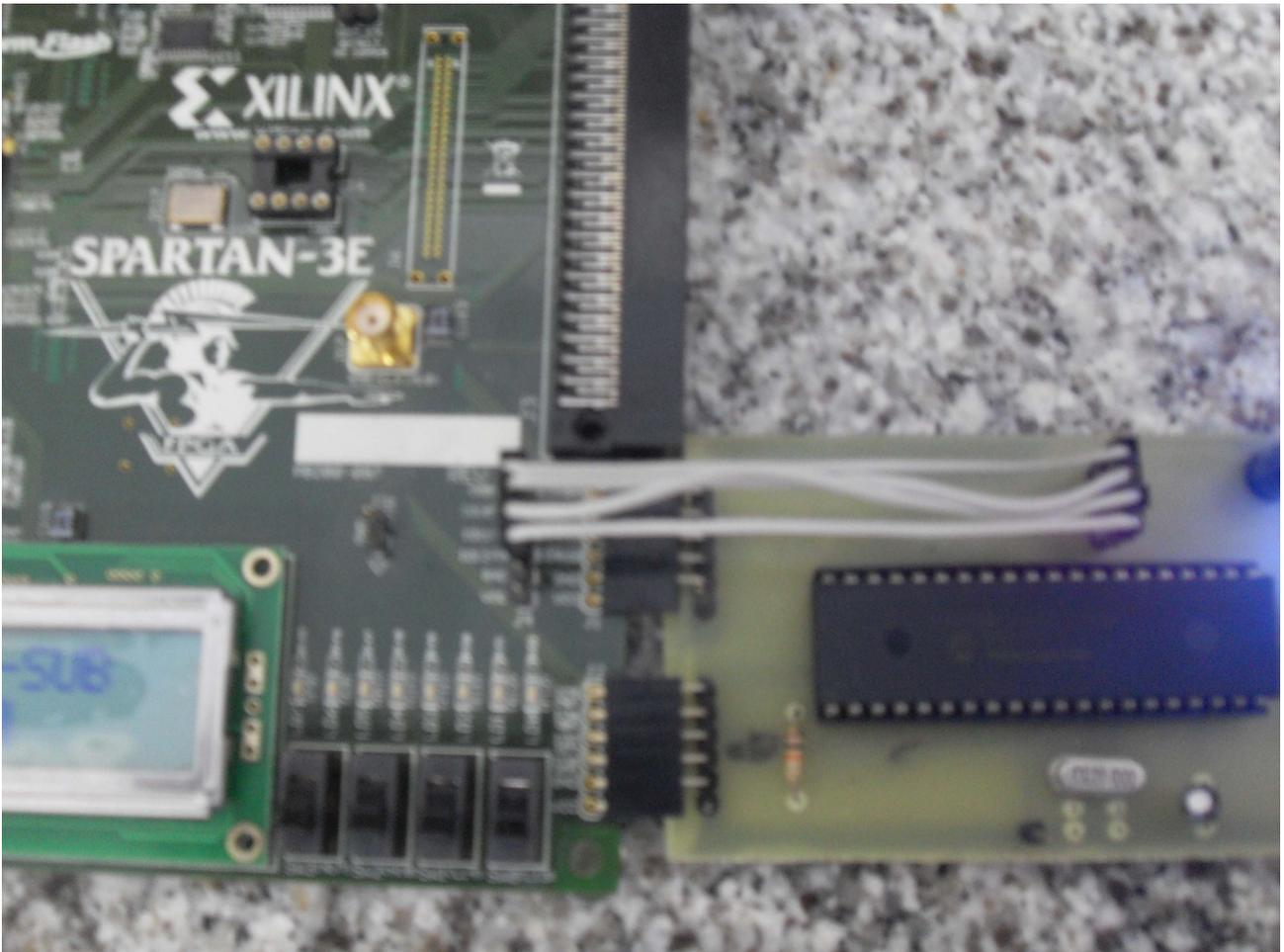
*Figura 5: Conexão entre as plataformas e o Flat Controller*
