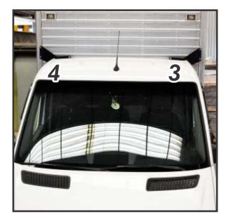
11) Posicione o teto montado sobre a cabine sem deixá-lo na posição final. Certifique-se que a borracha de vedação mantenha toda a extensão da sua aba para fora do defletor. Mantenha uma abertura lateral que seja suficiente para permitir que seja trabalhado dentro do defletor.
