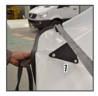
5) Depois de encaixada a borracha, na parte interna do teto, a cada 5cm a 10cm ponha um ponto de cola dentro da borracha. Isso servirá para evitar que a borracha deslize.
