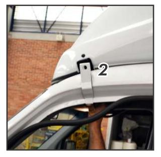
14) A fixação dos grampos (2) no rack dianteiro (1) são feitos com 2 parafusos de cada lado 1 encaixado horizontalmente e outro verticalmente.
