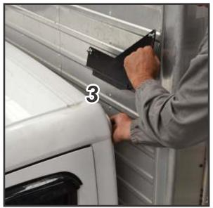
9) O conjunto do mordente e suporte deve ser fixado conforme a imagem. Fixe esse conjunto utilizando em cada lado da cabine 2 arruelas lisas 8mm e 2 porcas autotravantes 8mm.
