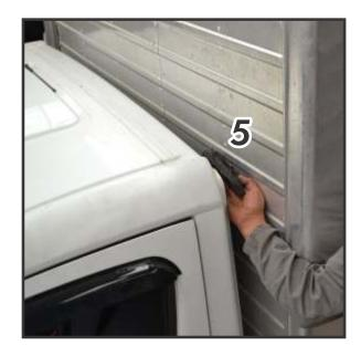
8) Logo, posicione os suportes de fixação lateral (3 e 4) sobre os frisos e o mordentes (5 e 7), de forma que os parafusos dos mordentes coincidam com os furos oblongos dos suportes.
