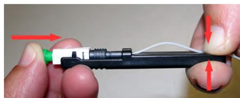
8. Mantendo a fibra de 900µ pressionada firmemente contra a base, com a outra mão desloque o conector contra a fibra de modo a selar a ligação. (Fig. 3)
