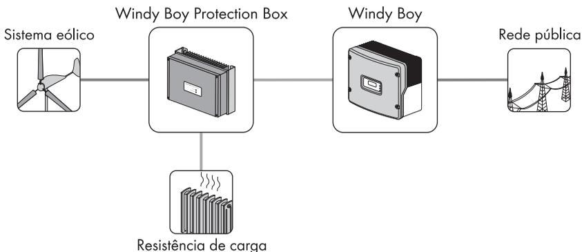
O Windy Boy pode, além disso, ser utilizado como inversor em sistemas de conversão de energia com base em geradores de ímanes permanentes (sistema de energia hidráulica, central de cogeração, gerador diesel, etc.). O fabricante do pequeno aerogerador ou do gerador deve ter homologado o seu sistema para a operação com este Windy Boy.
