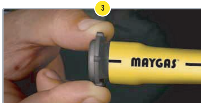
Passo 3. Transcorrido o tempo adequado a cada diâmetro (ver Tabela de Tempo de Solda para o tempo de aquecimento e resfriamento), ambos elementos são retirados dos bocais e devem ser unidos.
