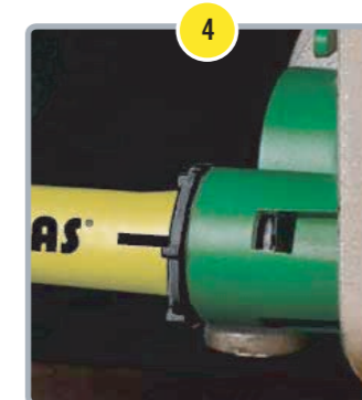
Passo 4. A introdução do tubo deve ocorrer até que a bucha se torne visível na janela do bocal.
