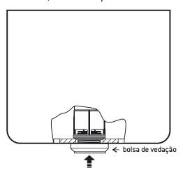
2- Encaixe a caixa acoplada na entrada da bacia sanitária.
