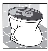
5- Coloque a bacia na posição de instalação, alinhando o tubo de esgoto à saída de esgoto da bacia.
