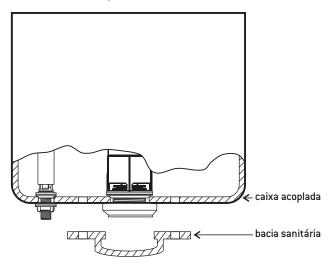
3- Fixe a caixa acoplada na bacia sanitária utilizando o conjunto de fixação. Atente para sequência correta de montagem.
