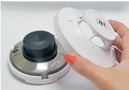
Após retirar a tampa, será visualizada a câmara. Retire-a e faça a limpeza. Tenha cuidado com a tela de proteção. Ao voltar a câmara, atente para recolocar corretamente a tela protetora, como mostra a figura 7.
