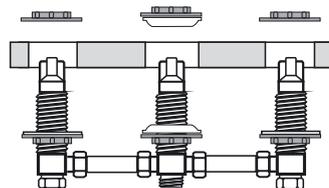
OBS: Caso necessário, corte os tubos de ligação para ajustar os registros à furação da louça (os cortes devem ser iguais nos dois tubos). Lime eventuais rebarbas, aperte as porcas manualmente.
