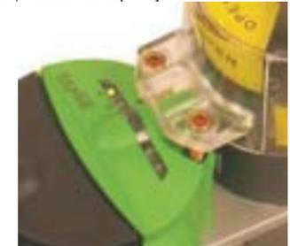
4° - Coloque a válvula na posição fechada, o led S2 deverá ascender, indicando a posição fechada da válvula.
