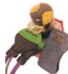
4° - Movimente a válvula para a posição fechada, o multímetro 2 na escala de resistência deverá indicar infinito.
