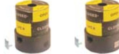
3° - Insira agora o outro alvo metálico na posição a 90°, observando o sentido em que o atuador pneumático irá girar.
