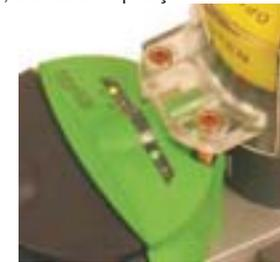
5° - Coloque a válvula na posição fechada, o led S2 deverá ascender, indicando a posição fechada da válvula.
