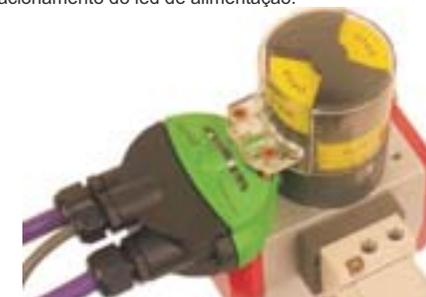
7° - Com o sensor S1 acionado, ou seja, com o alvo metálico ou magnético posicionado na frente do alvo superior do sensor, o seu respectivo led deverá acender.
