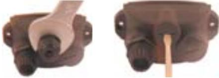
10.1 - Retire o prensa cabo nº 3 com a ajuda de uma chave de boca 19mm.
