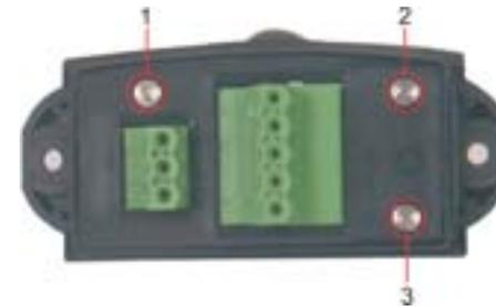
4° - Com o auxílio de uma chave de fenda adequada, retire os três parafusos da caixa de conexões para ter acesso ao conector.
