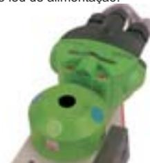
9° - com o sensor superior S1 acionado, ou seja com o alvo metálico posicionado na frente do sensor superior o seu respectivo led deve estar aceso.
