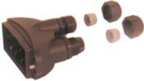
10° Instale agora o cabo da solenóide no prensa cabos nº 3, repetindo os passos 6, 7 e 8. Caso o sensor não seja conectado a nenhuma solenóide, substitua o prensa cabos por um tampão PG 9 (cabos de 4 a 8mm). Siga os passos abaixo:
