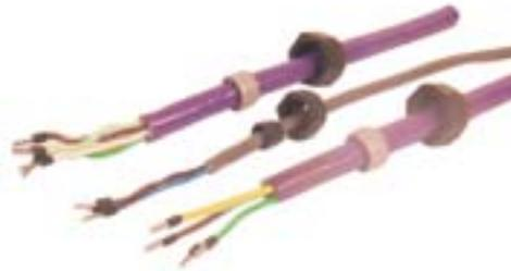
12° Introduza os cabos pelos furos dos prensa cabos e monte os prensa cabos mas não aperte em demasia.
