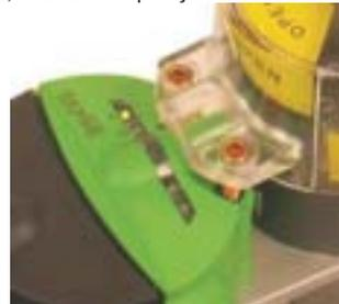
4° - Coloque a válvula na posição fechada, o led S2 deverá ascender, indicando a posição fechada da válvula.
