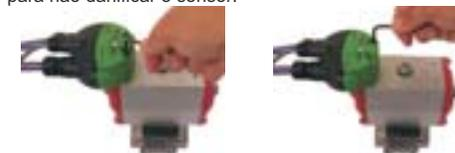
3° - monte o "copinho" sobre o atuador pneumático inserindo os distanciadores quando necessário de acordo com a altura do eixo:
