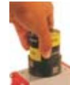
4° - Agora coloque o sensor sobre o atuador, em seguida o acrílico sobre o indicador local.
