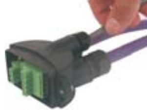
16° Coloque a tampa do conector, se necessário movimente os conectores para que a tampa possa ser encaixada.
