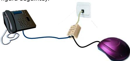
**ATENÇÃO: a instalação destes filtros é FUNDAMENTAL para o correcto funcionamento do serviço telefónico e do serviço ADSL!**
