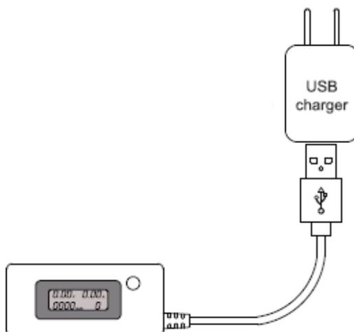
O dispositivo deve possuir um conector USB normal para a entrada e um micro conector USB que pode ser usado diretamente com qualquer carregador USB normal.
