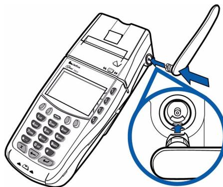
**Figura 9** Instalação da antena
