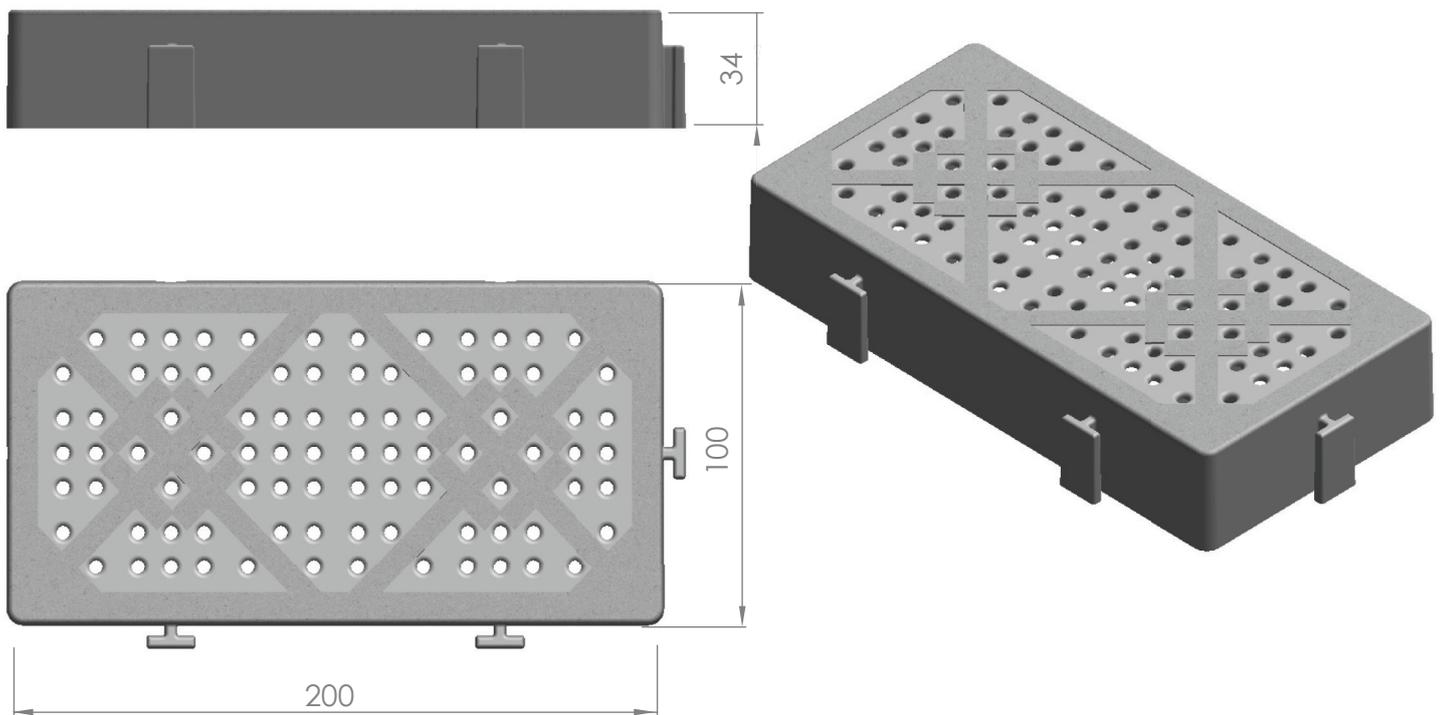
Figura 1 – Dimensões do Plastpaver®
