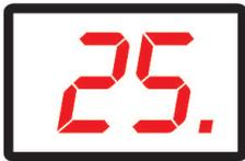
Um ponto na parte inferior à direita do Display, indica que a temperatura não chegou na programada, quando apagar o ponto, indica que chegou na temperatura programada.
