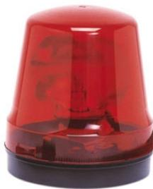
Sinalizadores visuais para advertência com cúpula injetada em policarbonato translúcido nas cores rubi, âmbar, azul e cristal, com base injetada em ABS de alta resistência. Os sinalizadores RT19 e RT19H são compostos de sistema rotativo com transmissão por engrenagens e micromotor, parábola refletiva metalizada, injetada em policarbonato e lâmpada incandescente de 21W ou lâmpada halógena 55W. O sinalizador RT19S é composto por sistema de flashes estroboscópicos e power supply incorporado.
