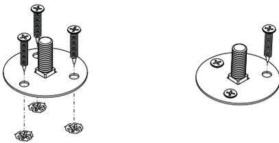
3º Passo - Com a base devidamente fixada, rosque o corpo da base (01), girando-o no sentido horário, de maneira que fique bem ajustado.
