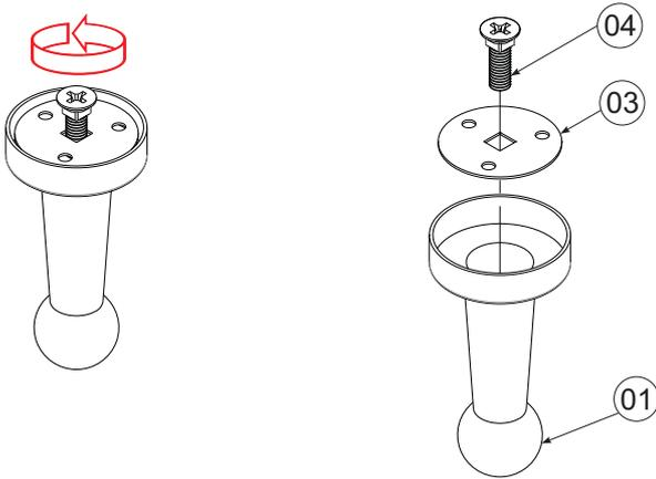
2º Passo - Introduza o parafuso (04) no furo quadrado da base de fixação (03) e fixe-a no piso (utilizando os parafusos (02) e ou as buchas de fixação (05)).
