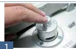
1. Antes de abrir a tampa, libere os gases do compartimento do tanque através do acionamento da válvula de alívio de pressão localizado na sobretampa.
