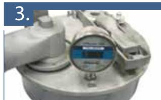
3. Realize agora o teste hidrostático verificando se há vazamento nas vedações do friso com a cinta e na sobretampa.
