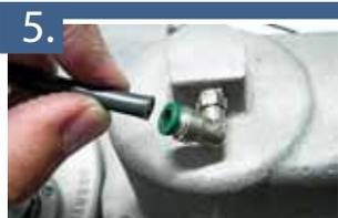
5. Realize a ligação pneumática na conexão da recuperadora de vapor utilizando o tubo de 1/4".
