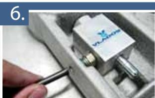
6. Realize também a ligação pneumática no cilindro pneumático utilizando o tubo de 1/4".
