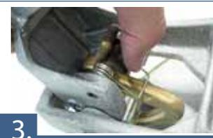
3. Após abrir o cabo da sobretampa, acione a alavanca do gancho para liberar a trava de segurança do segundo estágio de abertura
