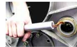
Antes de realizar a vaporização do tanque desconecte a fiação e remova a haste do sensor por baixo da tampa. O vapor pode danificar o sistema de funcionamento e as guarnições.
