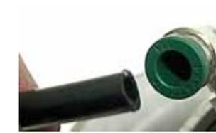
Lubrifique o cilindro e as ligações pneumáticas. Desconecte a mangueira da conexão e pingue cinco gotas de óleo no furo a cada 15 dias.
