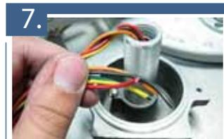
7. Realize as ligações elétricas do sensor de nível. Mantenha a atenção para realizar a ligação correta dos fios.
