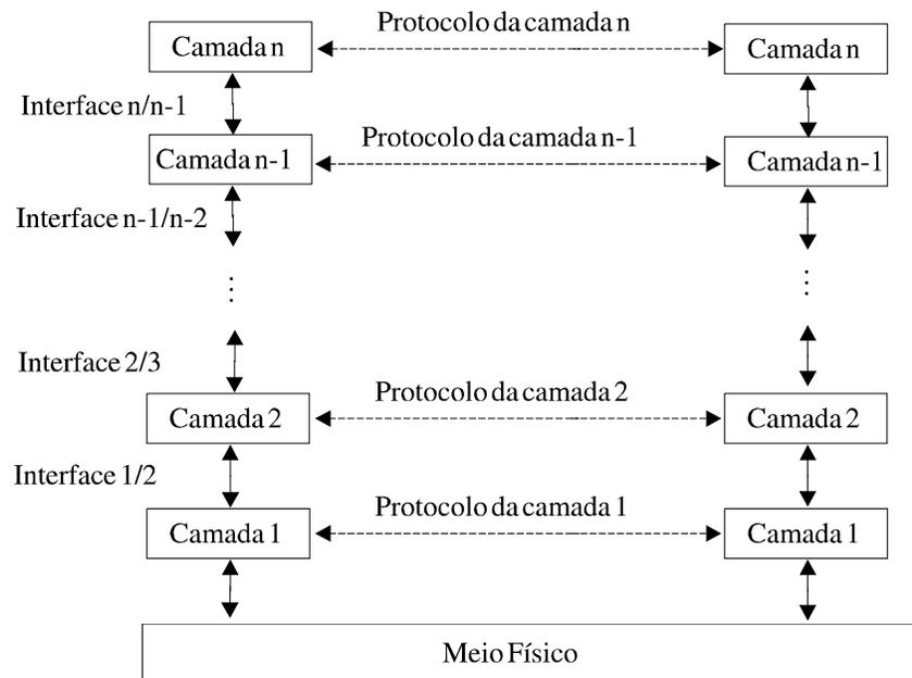
Entre cada par de camadas adjacentes existe uma interface. A interface define quais operações primitivas são oferecidas pela camada inferior para a camada superior.
