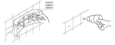
Encaixe as buchas na parede. Em seguida, fixe o suporte com as arruelas metálicas e parafusos, utilizando uma ferramenta. Fit wallplugs into holes and attach support using screws and metal washers
