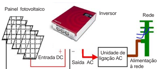
Fig. 1. Diagrama típico de ligação de um sistema fotovoltaico.
