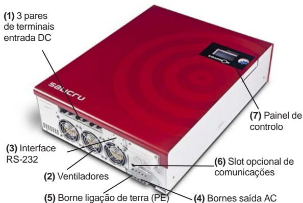
Fig. 2. Vista partes constituintes EQX-10000
