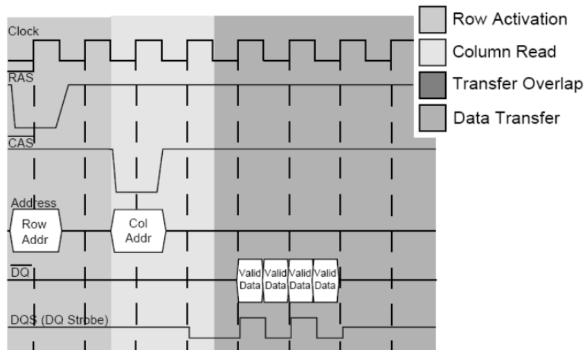
Figura 5.62 – Ilustração dos sinais no barramento de uma memória DRAM síncrona – DDR SDRAM.
