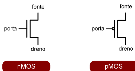
Figura 2.26 – Símbolos eléctricos dos transístores nMOS e pMOS.
