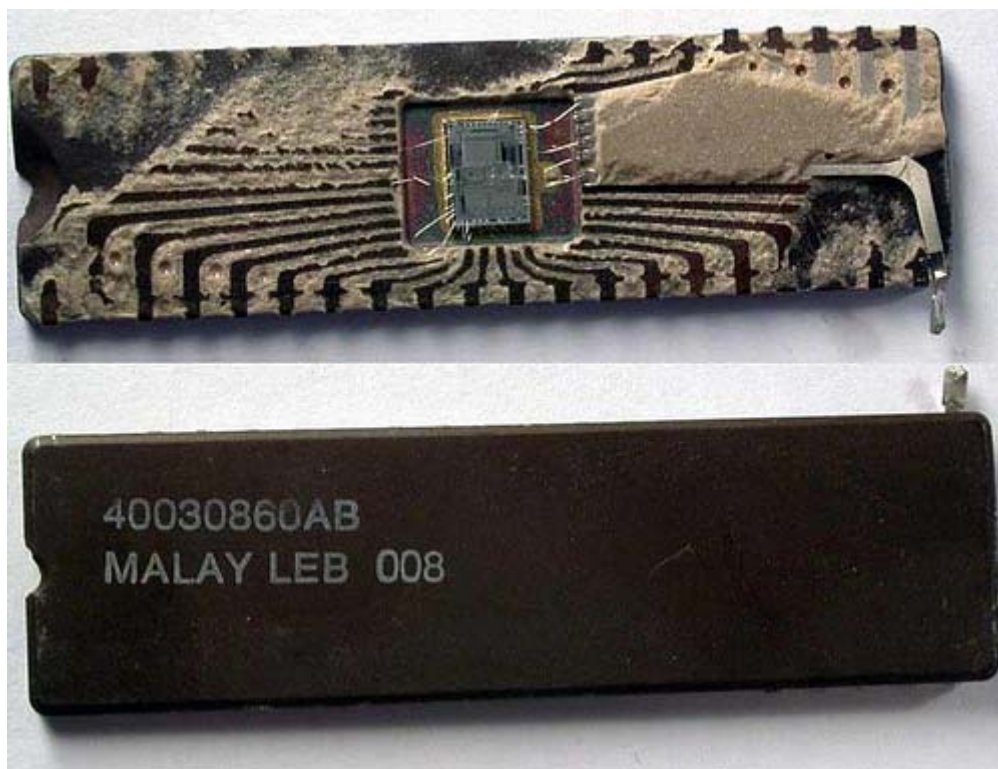
Figura 2.71 – Fotografia do encapsulamento de um microcontrolador da Intel, modelo 8742. Tirada por Ioan Sameli. Licença Creative Commons: Atribuição-Compartilhamento pela mesma Licença 2.0 Genérica.
