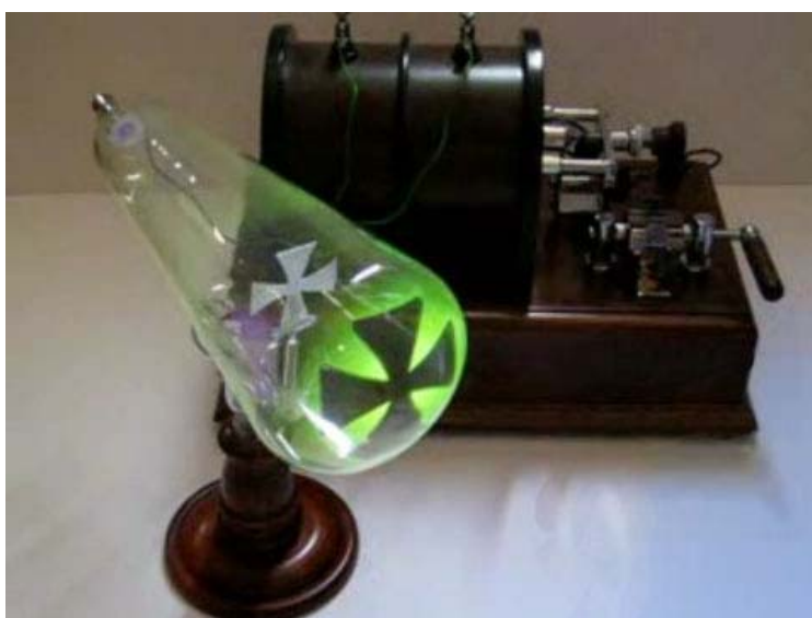
Figura 2.6 – Fotografia de um tubo de Crookes com uma Cruz de Malta no seu interior.
