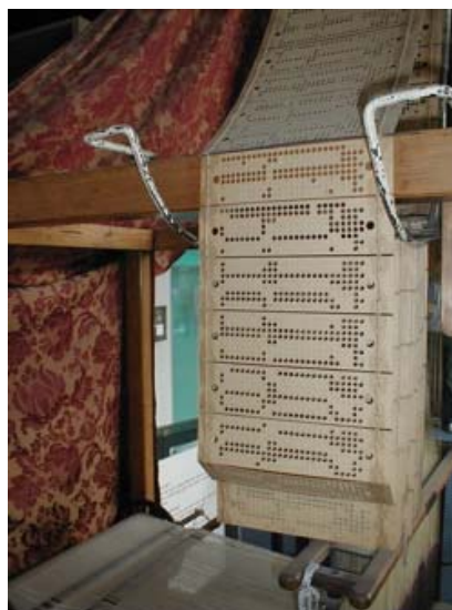
Figura 2.1 – Fotografia do tear de Jacquard e dos cartões perfurados usados para determinar o padrão criado no tecido.
