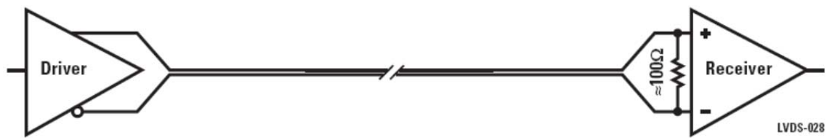
Figura 6.34 – Diagrama de uma ligação diferencial do tipo LVDS.
