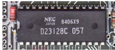
Figura 5.14 – Fotografia de um circuito integrado fabricado em 1983 contendo uma memória PROM e usado no computador Sinclair 48k ZX Spectrum. Tirada por Bill Bertram. Licença Creative Commons Attribution (CC-BY).
