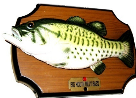
Figura 5.13 – Fotografia de um peixe robótico que canta quando alguém se aproxima. Possui uma memória Mask ROM que armazena o programa para controlo dos motores que fazem a cabeça e barbatana mexer e também 30 segundos de música.
