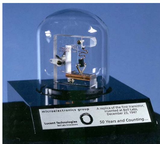
Figura 2.19 – Fotografia de uma réplica do primeiro transistor construído.
