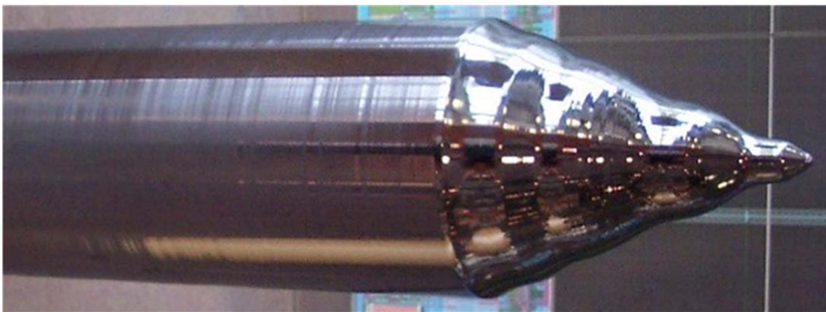
Figura 2.55 – Fotografia de um cilindro de polisilício. Fonte: Wikipedia, publicada por Stahlkocher. Licença: Creative Commons Attribution ShareAlike 3.0.
