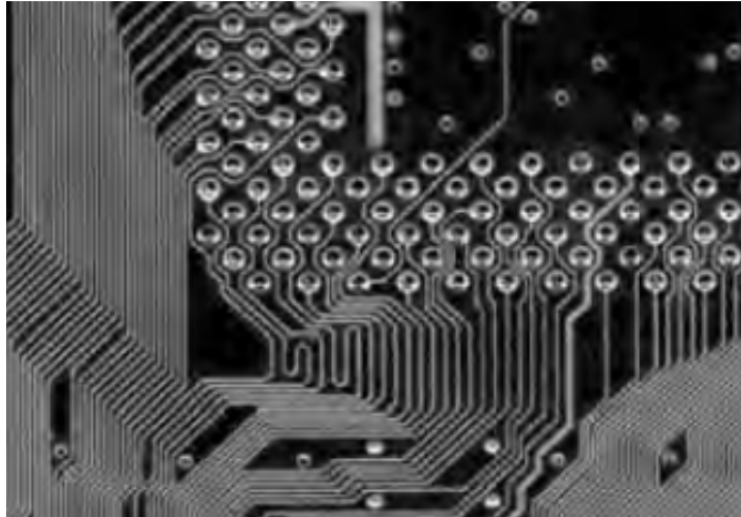
Figura 6.17 – Placa de circuito impresso mostrando pista cujo comprimento foi tornado propositadamente mais longo do que seria de esperar.
