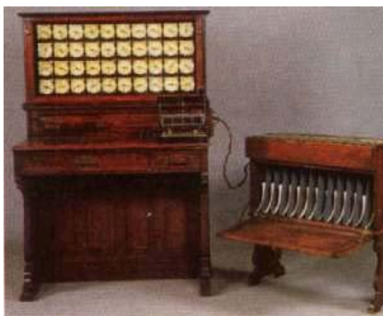
Figura 5.4 – Fotografia do computador mecânico criado por Herman Hollerith para realização do censo da população nos Estados Unidos da América em 1890. Retirada de http://www.computersciencelab.com/ComputerHistory/HistoryPt2.htm .
