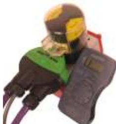
4º - Movimente a válvula para a posição fechada, o multímetro 2 na escala de resistência deverá indicar infinito.
