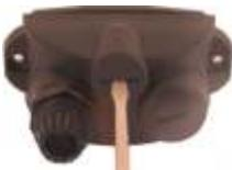
12º Com todos os cabos preparados, insira a porca dos prensa cabos e a borracha de vedação nos cabos que serão utilizados.
