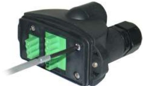
5º - Desencaixe a tampa que prende os conectores a caixa de conexões.
