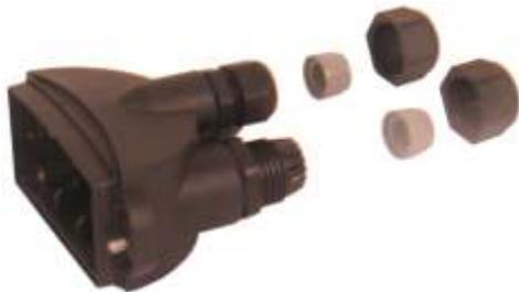
10º Instale agora o cabo da solenóide no prensa cabos nº 3, repetindo os passos 6, 7 e 8. Caso o sensor não seja conectado a nenhuma solenóide, substitua o prensa cabos por um tampão PG 9 (cabos de 4 a 8mm). Siga os passos abaixo:
