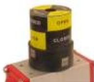
2º - Coloque o parafuso M6x 30mm para fixação do indicador local ao eixo do atuador e aperte-o com uma chave adequada mas não aperte demasiadamente afim de possibilitar o ajuste dos acionadores.
