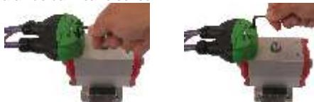
3º - monte o "copinho" sobre o atuador pneumático inserindo os distanciadores quando necessário de acordo com a altura do eixo:
