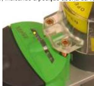
4º - Coloque a válvula na posição fechada, o led S2 deverá ascender, indicando a posição fechada da válvula.
