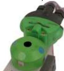
9º - com o sensor superior S1 acionado, ou seja com o alvo metálico posicionado na frente do sensor superior o seu respectivo led deve estar aceso.
