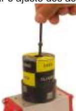
3º - Ajuste o indicador local girando-o com a mão de modo que o alvo metálico superior fique sob o sensor 1 e o alvo metálico inferior a 90º, observando o sentido em que o atuador irá girar, então aperte o parafuso de fixação do indicador local.
