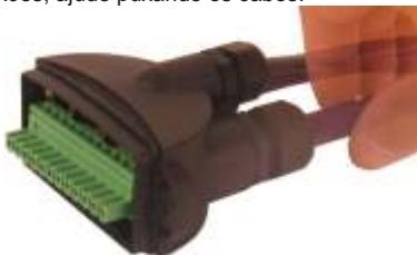
16º Coloque a tampa do conector, se necessário movimento o conector para que a tampa possa ser encaixada.
