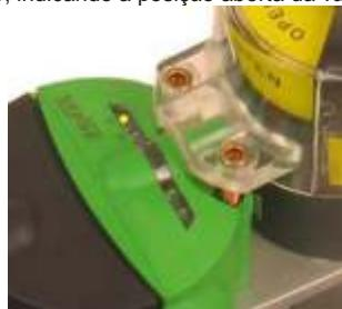
4º - Coloque a válvula na posição fechada, o led S2 deverá acender, indicando a posição fechada da válvula.
