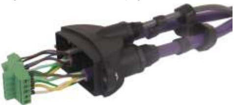
14º Empurre os conectores para dentro da caixa de conexões, ajude puxando os cabos.
