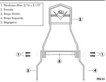
1º Passo - Montagem do Sissy Bar por completo fora da moto. Posicione o encosto do passageiro por entre o bagageiro em seguida coloque os braços direito e esquerdo na posição e fixe com os parafusos. Fig. 01.
