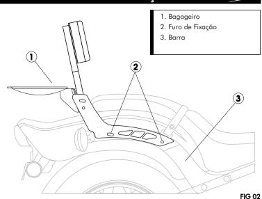
2º Passo - Após a montagem, retire os parafusos da espada em seguida apoie o Sissy bar sobre a espada para fixar com os parafusos que acompanham o conjunto. Faça o ajuste final para garantir que o conjunto está fixo e seguro.
