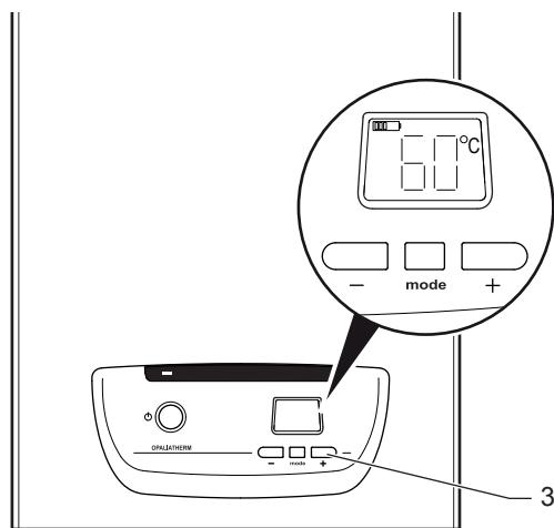
El aparato suministra una temperatura constante del agua, independientemente del volumen de salida y de la temperatura del agua fría de entrada.
