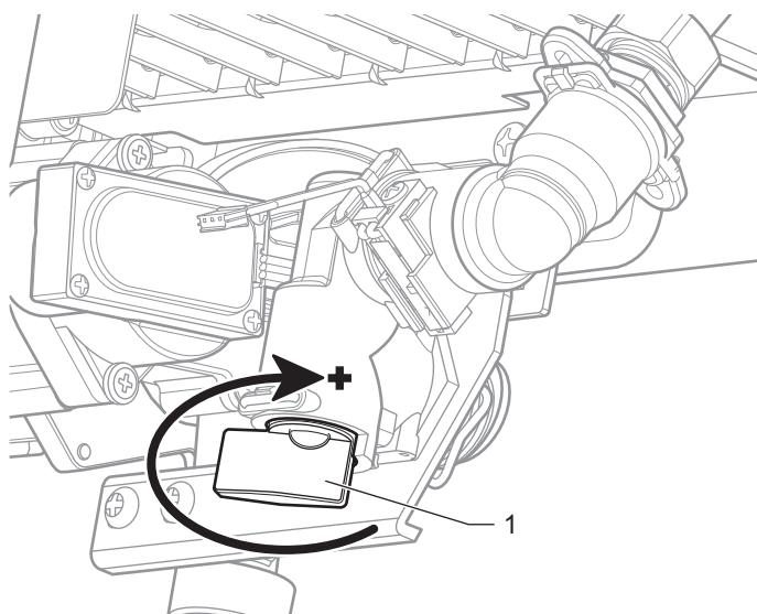
O instalador pode reajustar o fluxo de água através do regulador do fluxo de água (1) de forma a disponibilizar um maior fluxo de água para optimizar o desempenho em instalações solares.
