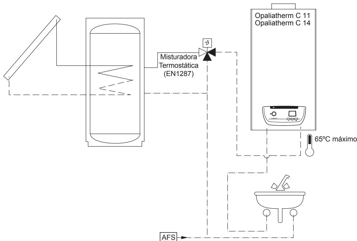
O esquentador termostático foi concebido para ser instalado também em instalações solares, pelo que deve existir uma válvula misturadora de água, regulada a uma temperatura máx. de 65°C, na ligação de entrada da água para proteger o aparelho. Consulte a Figura 4.6 para ver a forma de ligação.
