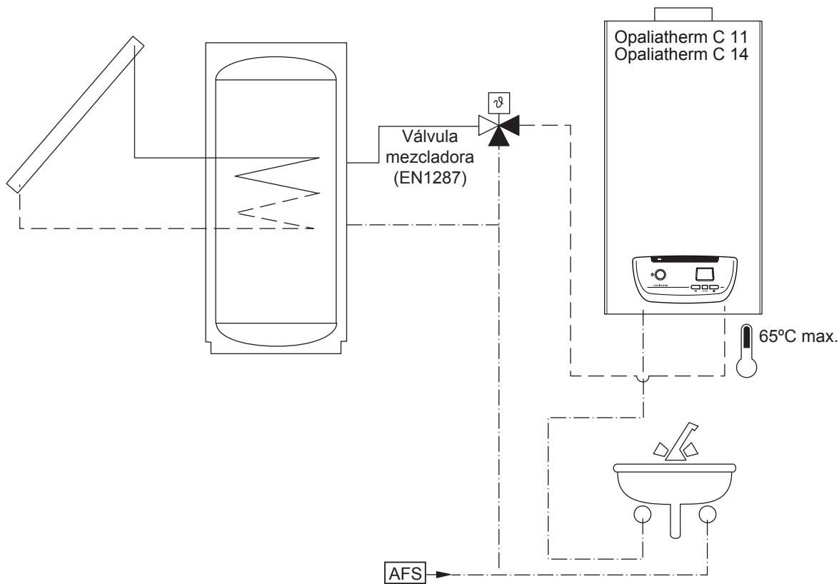
El calentador de agua termostático se ha diseñado para instalarse también en instalaciones solares, por lo que debe haber una válvula de mezclado de agua, ajustada como máximo a 65°C, en la conexión de entrada del agua para proteger el aparato. Consulte la Figura 4.6 para ver la forma de conexión.
