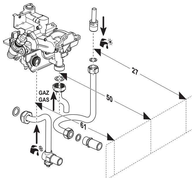
La distancia de la pared a la conexión del gas es 50 mm.
