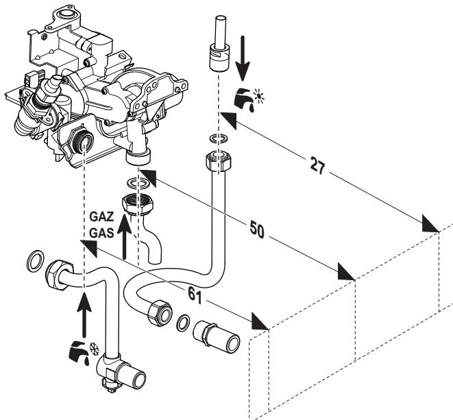
A distância entre a parede e a ligação de gás é de 50 mm.
