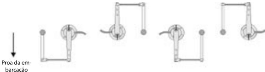
**Satisfatório:** Disposição em U com o braço não paralelo ao comprimento da embarcação, por exemplo:
