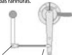
Rode a base de forma a que a seta no braço aponte para a linha central na base. Instale o terceiro parafuso fornecido e aperte todos os parafusos.
