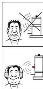
**Nível de ruidos:** Los niveles de ruido de un impactador instalado sobre una placa de metal y sin pantallas protectoras podrán exceder de 85 dB (A). El sonido de emitido por el equipo se puede reducir usando sistemas de revestimiento
