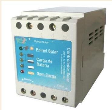
Na descarga, controla a quantidade de energia, avisando e desligando o consumo antes que a bateria se descarregue. Na recarga, libera a energia para consumo automaticamente, após atingir uma capacidade segura. Possui, também, proteções para não danificar os equipamentos conectados.
