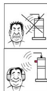
**Nivel de ruidos:** Los niveles de ruido de un impactador instalado sobre una placa de metal y sin pantallas protectoras podrán exceder de 85 dB (A). El sonido emitido por el equipo se puede reducir usando sistemas de revestimiento.
