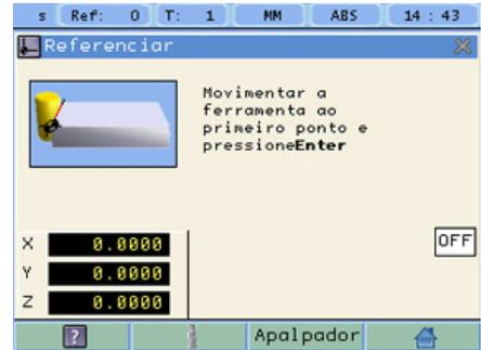
**[Eixo Z]** Ativar a referência do eixo Z.
