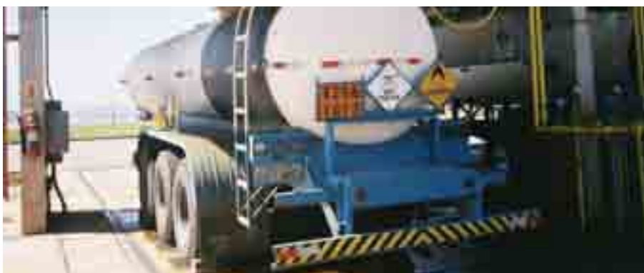
Carroceria de caminhão com o cilindro de cloro gasoso
