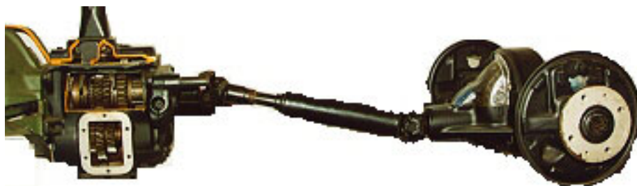
FIG.10- SISTEMA DE TRANSMISSÃO DE UR- GM FONTE: CSM/MOpB
