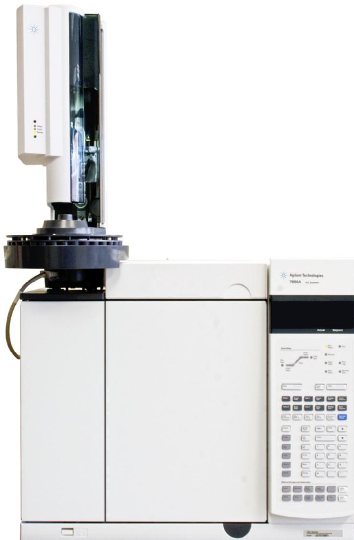
**Figura 18** ALS instalado em um GC 7890A
