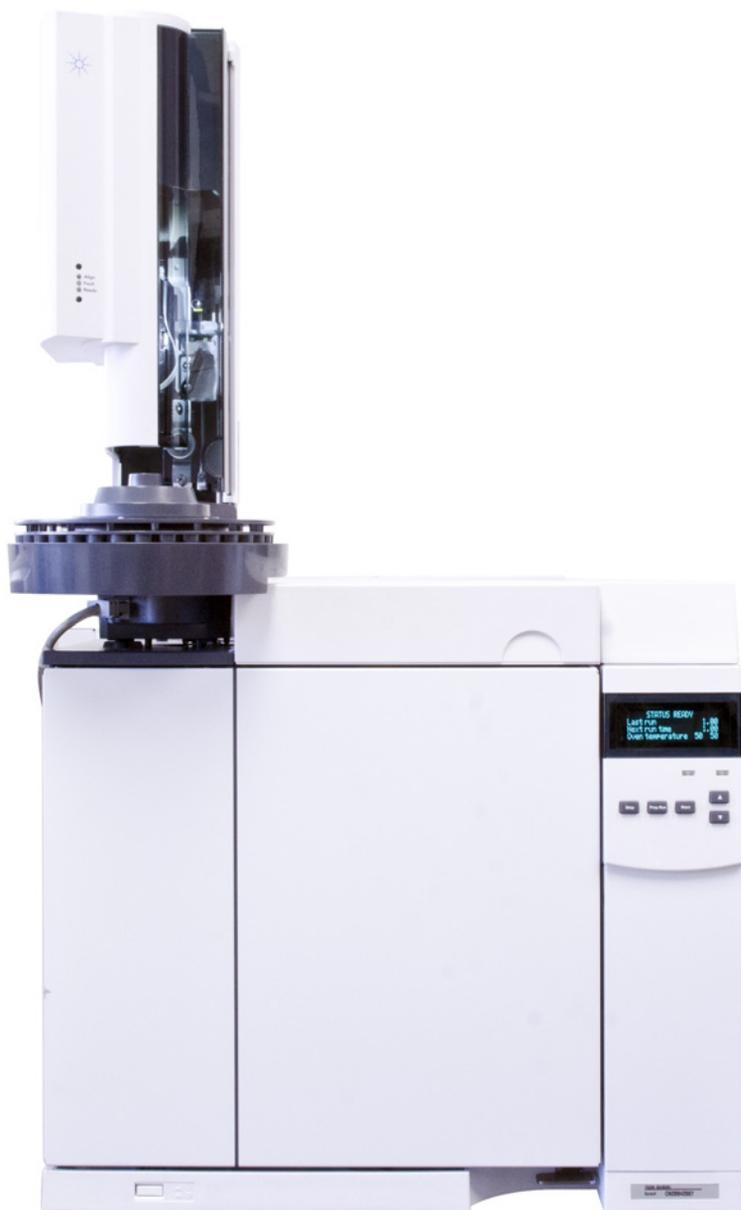
**Figura 19** ALS instalado em um GC 7820A
