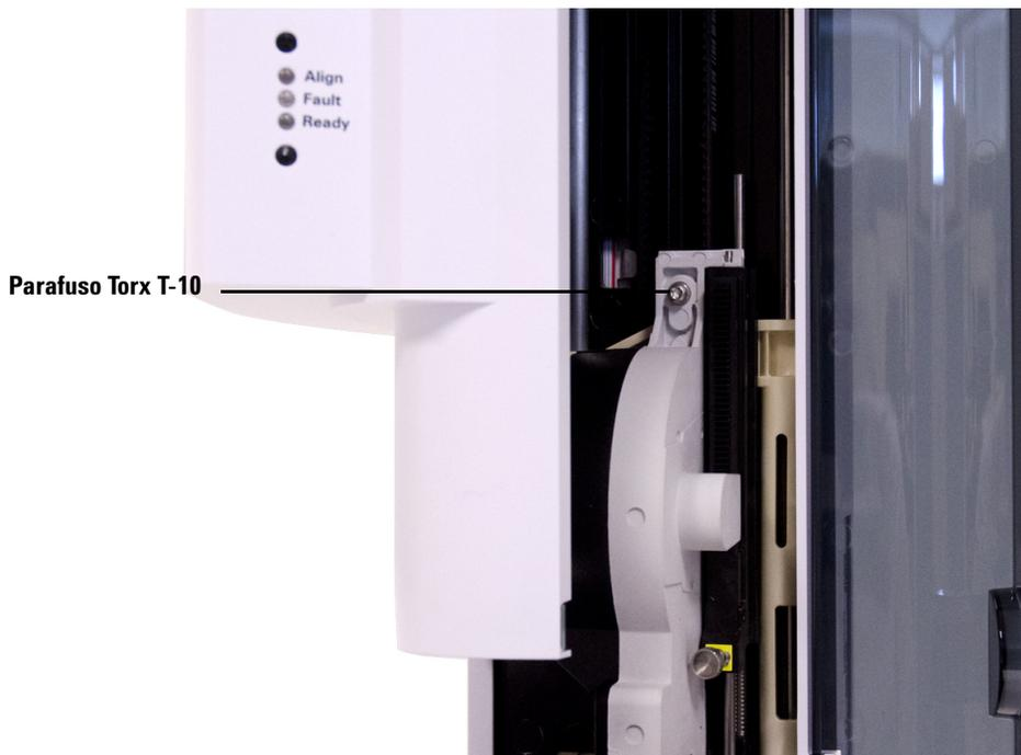
**Figura 69** Apertar o parafuso Torx T-10 na parte superior do portador de seringa
