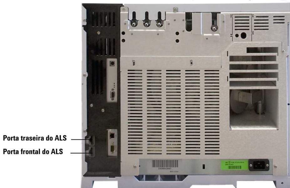
**Figura 16** Portas frontal e traseira do ALS na parte de trás de um GC 7820A
