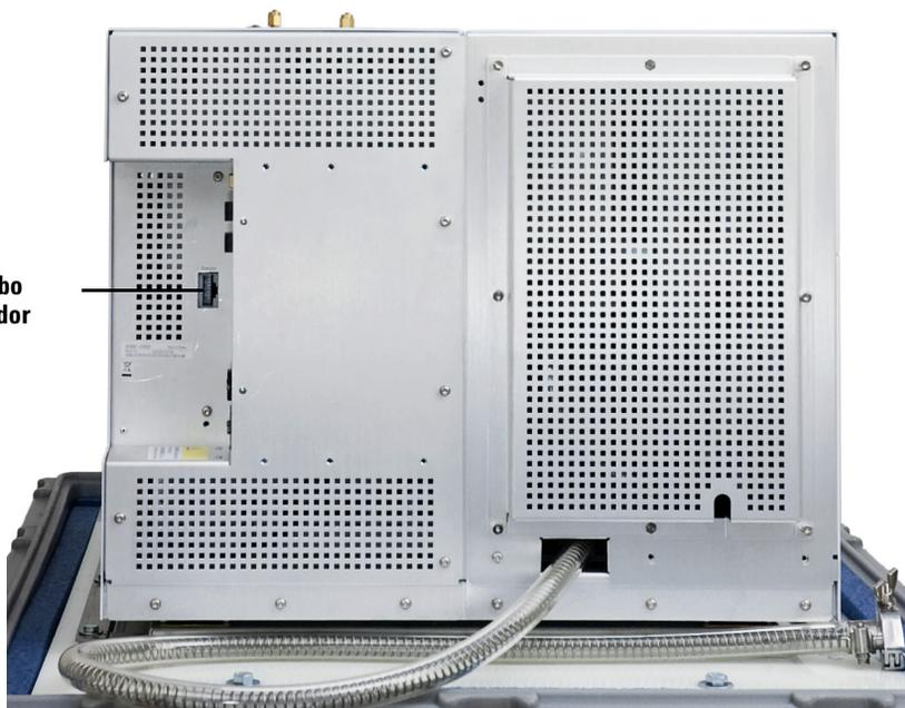
**Figura 17** Porta do cabo do amostrador na traseira de um LTM-GC/MSD 5975T
