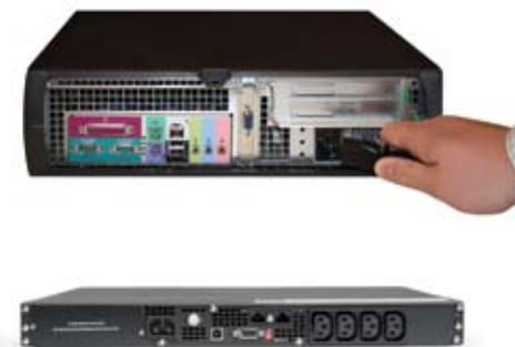
Retire o cabo de alimentação padrão 5-15P/C13 que foi fornecido com o equipamento de TI e substitua-o por um dos cabos de jumper C13/C14 que acompanha o seu no-break. Agora, seu equipamento de TI está operando a 208V, funcionando de forma mais eficiente e economizando seu dinheiro.
