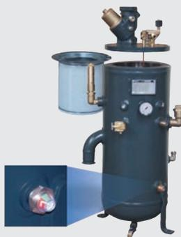
Um separador de três estágios (ASME ou CRN) possui uma ação centrífuga e um filtro coalescente de dois estágios reduz os resíduos para 2 ppm ou menos. Os encaixes rápidos, os drenos e orifícios bem posicionados possibilitam trocas de óleo do cárter e do resfriador de maneira rápida, fácil e sem precisar de nenhum dispositivo para bombear. O indicador de nível de óleo pode ser facilmente verificado sem precisar abrir ou parar o compressor.
