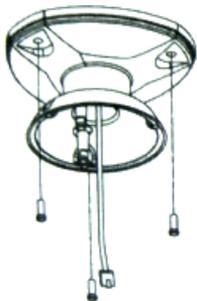
② Conectar os cabos de conexão na câmera. Inserir a câmera nas travas de montagem (girar) e fixar os 3 parafusos de trava.
