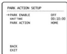
Se Park Enable (Habilitar Estacionamento) estiver ajustado para ON, a câmera irá ativar a função atribuída automaticamente se não houver nenhum comando PTZ durante "Wait Time" (Tempo de Espera) atribuído.
