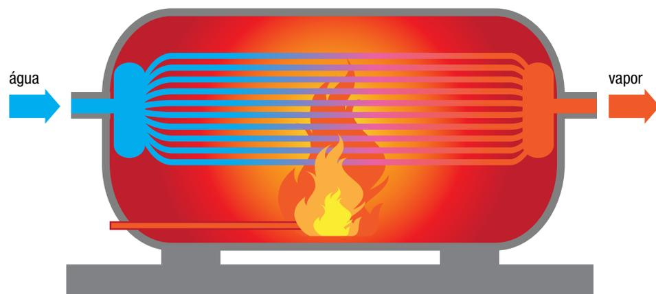
Uma caldeira aquatubular pode custar até 50% mais do que uma caldeira flamotubular de capacidade equivalente. Ela apresenta, porém, algumas vantagens, como uma maior capacidade de produção de vapor por unidade de área de troca de calor e a possibilidade de utilizar temperatura superior a 450 °C e pressão acima de 60 kgf/cm<sup>2</sup>.
