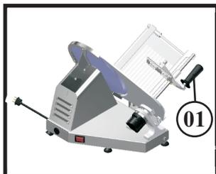
Modelo CFI-300LR-N, o avanço da Mesa Móvel é manual. Sendo feito através do Manipulo do Empurrador N°01 (Fig.05)
