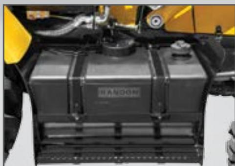
material plástico antichama (ICORENE 1613), elimina o risco de oxidação interna. Possui proteção metálica inferior, traseira e lateral e foi testado conforme norma NBR ISO 11472.
