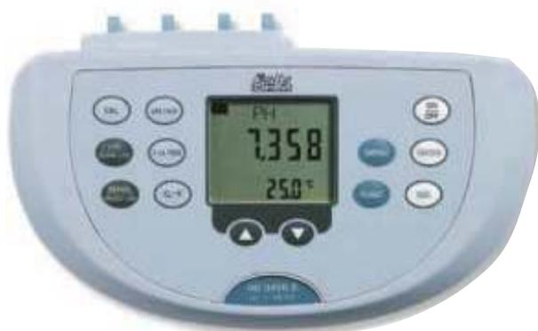
A família dos instrumentos HD34... é composta de quatro instrumentos de bancada para as medições electroquímicas: pH, condutividade, oxigénio dissolvido e temperatura.
