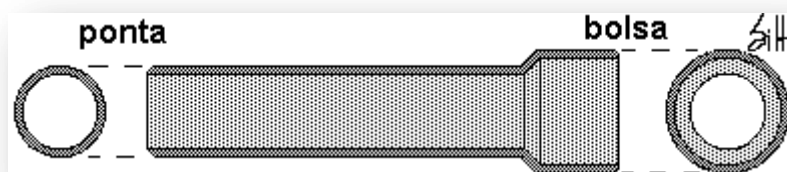
Figura6– Desenho esquemático de uma manilha cerâmica com ponta e bolsa
