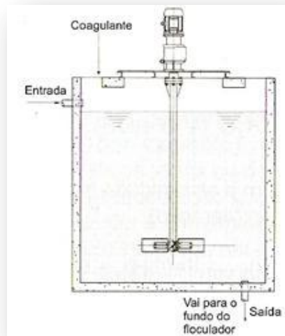
Figura 31 – Tanque de mistura rápida mecanizado.
