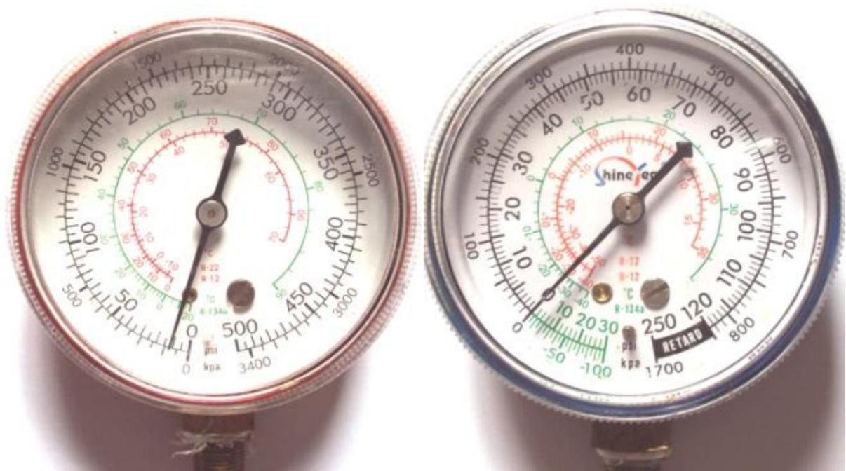
Figura 34- Medidores de alta e baixa pressão.
