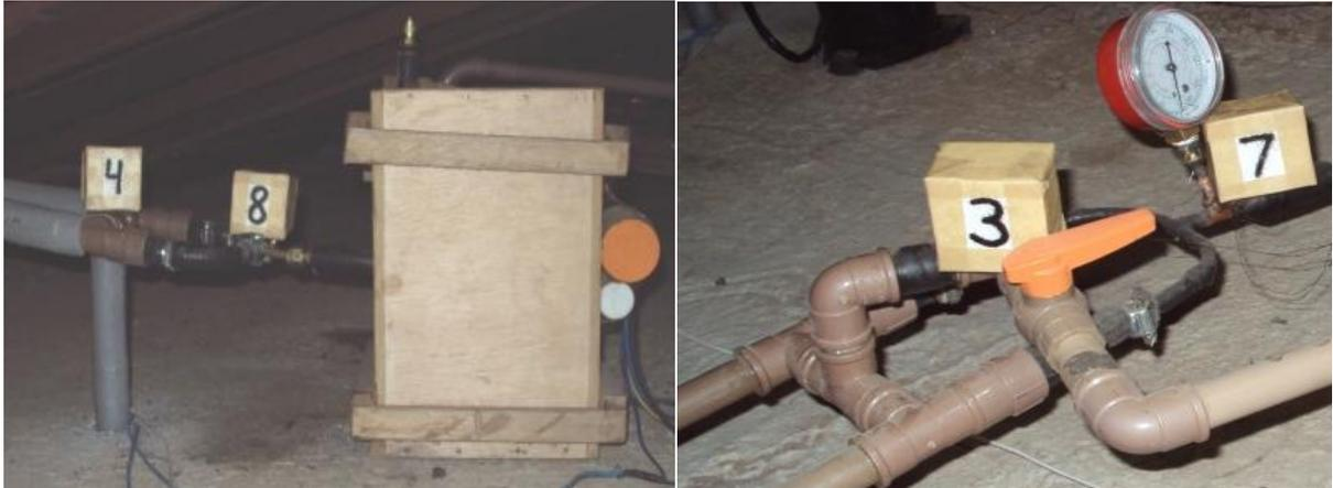
**Figura 23 - Detalhes dos pontos de entrada e saída de água e refrigerante no condensador**
