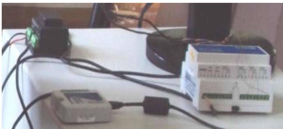
**Figura 41 – Datalogger, conversor USB e transformador**
