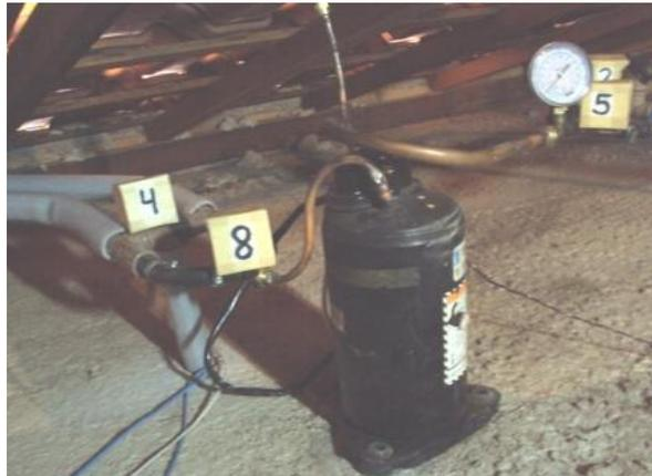
**Figura 21 - Compressor rotativo utilizado no protótipo.**
