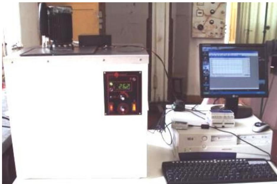
**Figura 42 - Banho térmico usado para aferição de termopares.**
