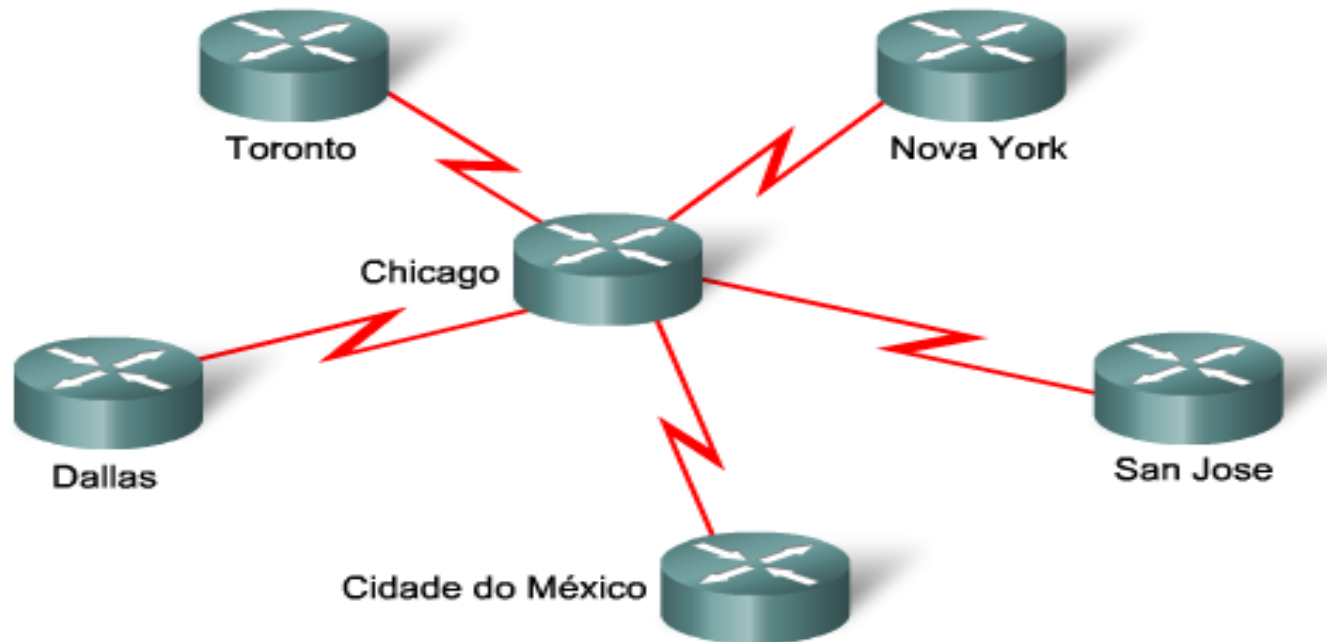
Topologia estrela - hub com 5 links físicos (spokes)
