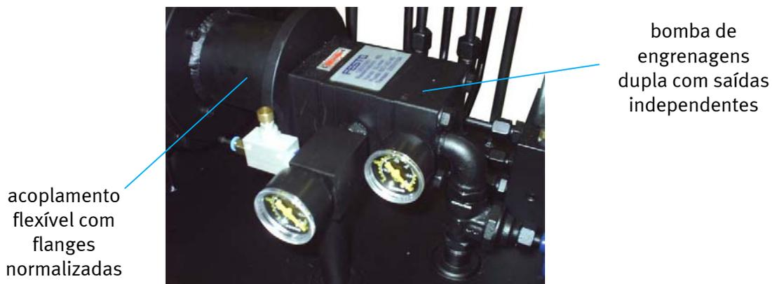
Cada bomba possui uma vazão de 5 litros de óleo por minuto, podendo operar na faixa de pressão de 0 a 100 bar.
