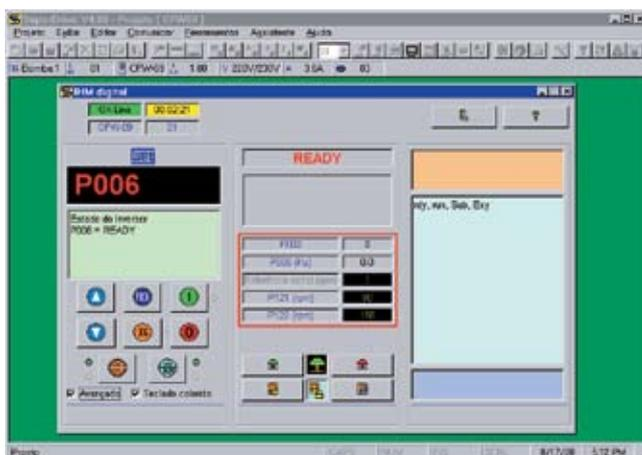
Software de Programação via microcomputador PC, em ambiente windows, para parametrização, comando e monitoração das gavetas com Soft-Starter e Inversor de Freqüência.
