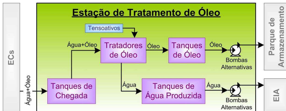
Figura 8: Visão geral de uma estação de tratamento
