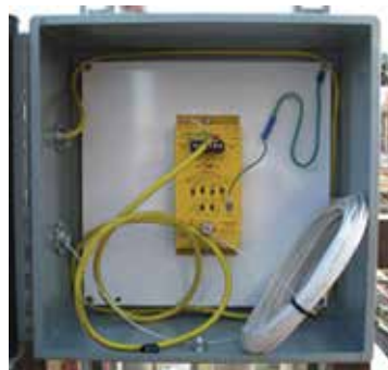
FIGURA 6 – Detalhe do Amplificador do Sensor Acústico.
