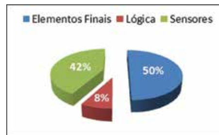
FIGURA 6 – Estatísticas dos principais causadores de falhas nos sistemas [9].
