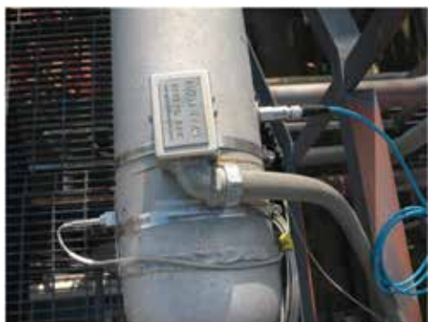
FIGURA 11 – Temperatura da Saída (esquerda), Sensor Ultrassônico (centro) e Acelerômetro (direita).
