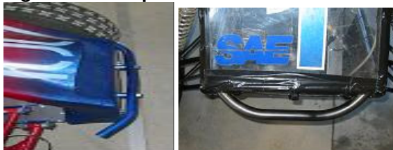
Figura 2 - Exemplos não aceitáveis de ponto de reboque dianteiro
