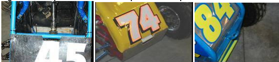
Figura 2 - Exemplos não aceitáveis de ponto de reboque dianteiro
