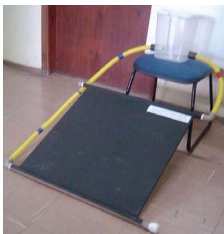
**FIGURA 12** – Coletor solar feito com forro de PVC – Sociedade do Sol
