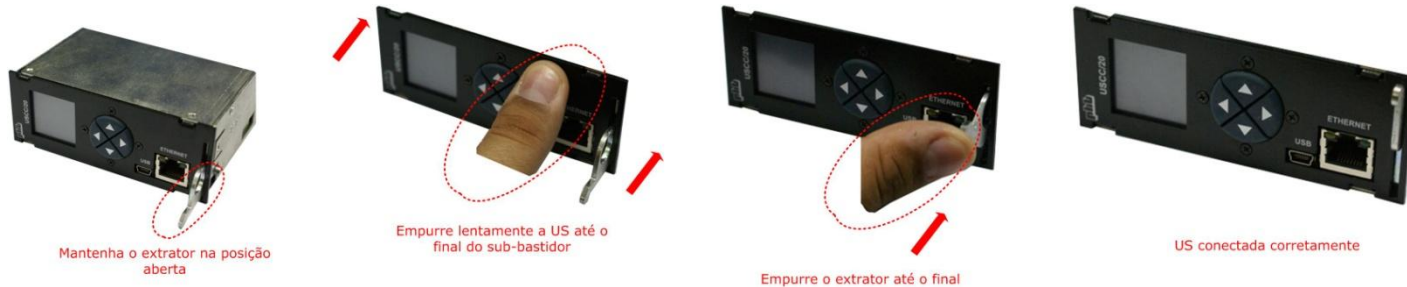
Figura 44c – Procedimento de conexão da US no sub-bastidor.
