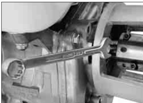
**C** - Aperte os quatro *parafusos* que servem para fixar a bomba na flange do motor.
